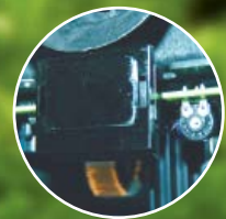
Detector automático de las manos Sensor electrónico por haz de luz infrarroja, regulable mediante un potenciómetro
