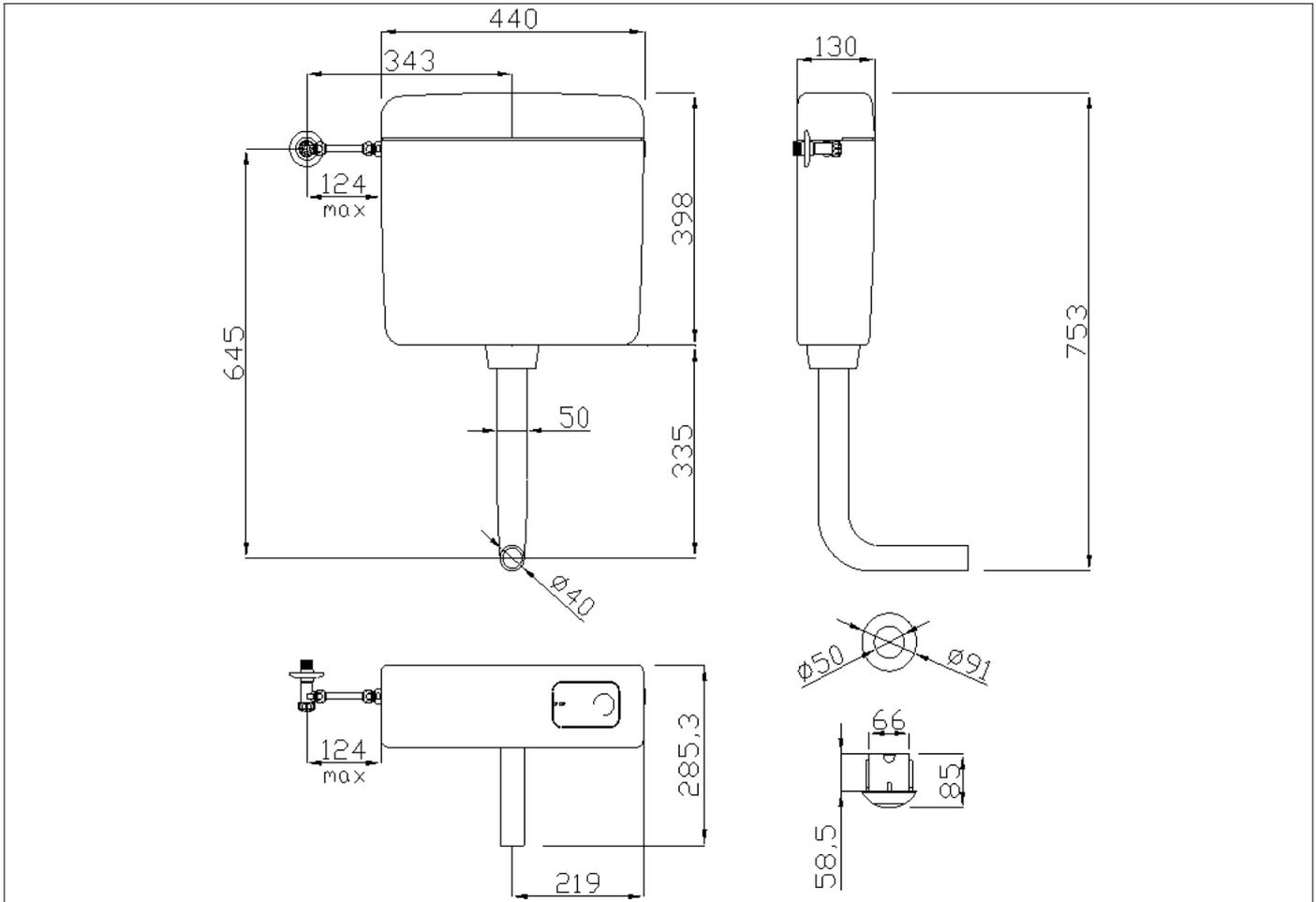
Cisterna de descarga con pulsador neumático de posición libre
