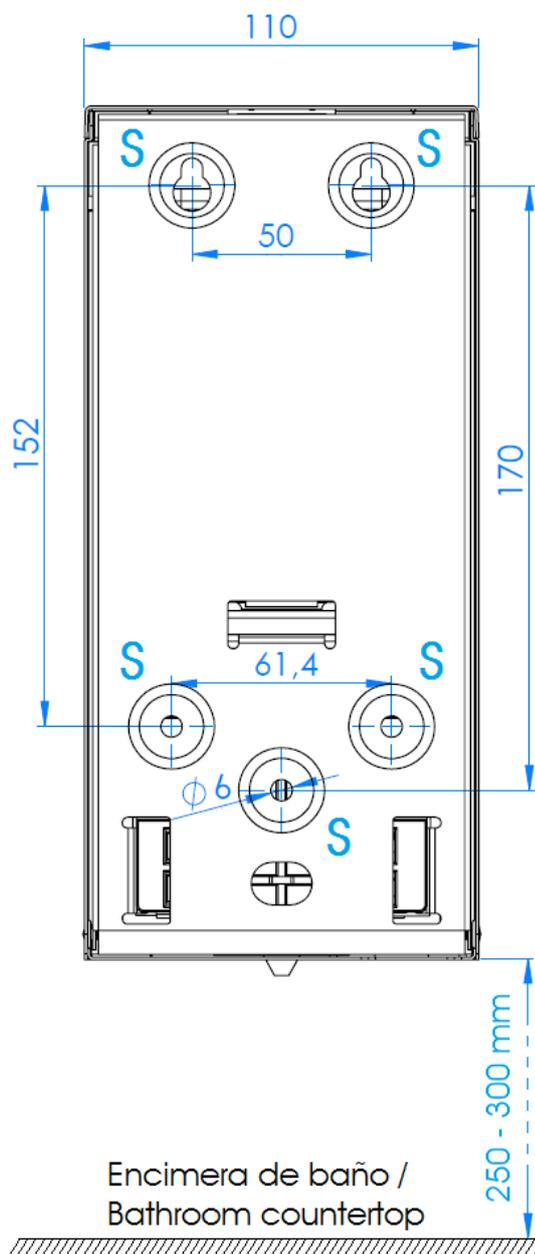
**ATENCIÓN:** no instalar este dosificador de jabón dentro de la ducha, ya que sus componentes eléctricos pueden resultar seriamente dañados por el agua y que el dosificador deje de funcionar. En caso de optar por la configuración con transformador eléctrico, instalar éste lejos de cualquier fuente de agua.
