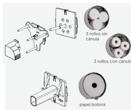
Fijar el dispensador de papel higiénico a la pared a 650-750 mm, del suelo al punto inferior, utilizando tornillos de acero inoxidable y a través de los agujeros de su placa trasera de montaje (agujeros indicados por un "S" en la figura inferior).
